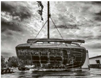
Schwere Geburt: Aufbauten eines 47-Meter-Explorers am Stahlseil
