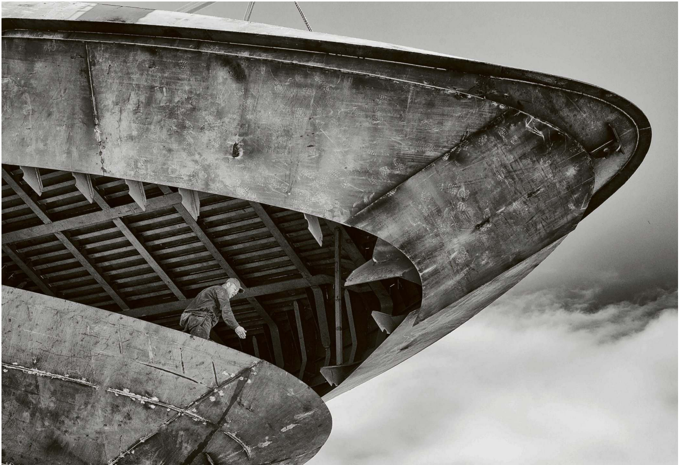
Hier nun: Die Bug-Sektionen einer 52-Meter-Stahlyacht werden zusammengefügt. Ein Projekt wie dieses frisst Zeit und Geld in großen Mengen.
